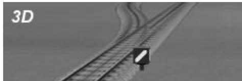
Im **3D-Fenster** ist an dieser Stelle eine **Weichenlaterne** zu sehen, die ebenfalls die **befahrbare Richtung** anzeigt. Die Lage der Weichenlaterne (links bzw. rechts neben Gleises) kann durch die Krümmung der Weichenschenkel in einer umgekehrten Reihenfolge beeinflusst werden.
