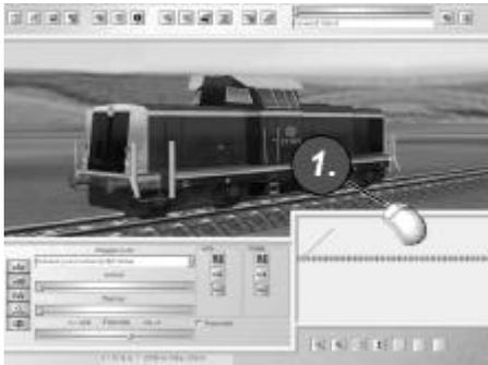
Hierzu muss das **Rollmaterial markiert** werden, damit diese Operation durchgeführt werden kann. Klicken Sie das Rollmaterial in der **3D-Ansicht** mit der linken Maustaste an und rufen mit der Schaltfläche **"Rollmaterial einsetzen"** das entsprechende Funktionsfenster auf.
