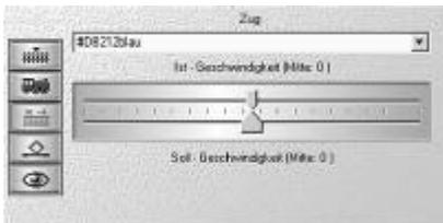
Im Auswahlménü der automatischen Steuerung kann ein auf der Anlage befindliches Rollmaterial ausgewählt werden. Die Auswahl des zuletzt markierten Rollmaterials wird aber auch vom Steuerdialog übernommen, wenn ein Rollmaterial zuvor manuell gesteuert wurde. Sobald der Eintrag in der Steuerkonsole übernommen wurde, kann die **Sollgeschwindigkeit** des Rollmaterials definiert werden. Stellen Sie hierzu den **unteren Slider** für die **Sollgeschwindigkeit** auf einen **gewünschten Wert**.
