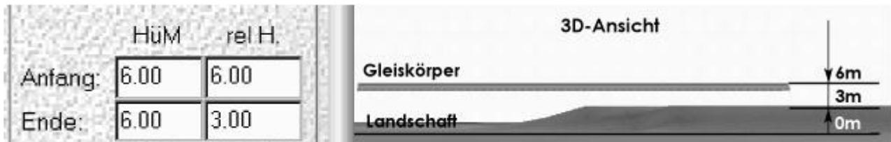
In folgendem Beispiel liegt das Gleis nicht nur 6m waagrecht über der Anlage, sondern auch in einer relativen Höhe zu einer darunter liegenden Erhebung.
