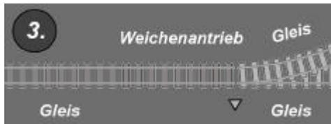
Im letzten Schritt wird der zweite (bei einer Dreiwegeweiche natürlich auch noch der dritte) Schenkel der Weiche gebildet, indem man ein **Gleis** an die noch **verbliebene** Anschlußstelle einrastet. Sobald alle Schenkel der Weiche vorhanden und korrekt angeschlossen sind, erscheint neben dem Weichenantrieb im Planfenster ein **orangefarbener Pfeil**, der die aktuelle **Stellung der Weiche**, also die befahrbare Richtung darstellt.
