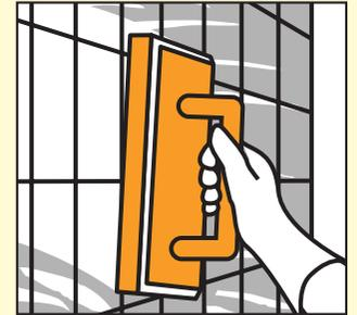
grob gereinigt werden. Nach dem Anziehen des Mörtels (er wird dabei matt) wird die verfugte Fliesenfläche zuerst mit einem feuchten Schwamm gereinigt und dann mit einem trockenen Tuch nachpoliert.
