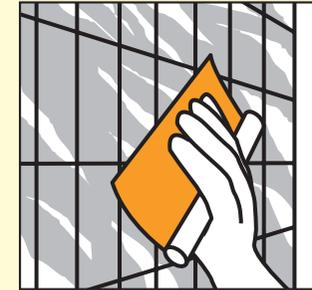
Die Fugenmasse wird nun mit einer Gummirakel oder dem Schwammbrett diagonal über die Fliesenfläche und in die Fugen hinein gestrichen. Die Masse muss hohlräumfrei eingearbeitet werden. Überschüssige Fugenmasse kann dabei abgetragen und die Fläche
