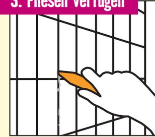
Achten Sie darauf, dass die Fugen kleberfrei bleiben. Kleberreste müssen vor dem Verfugen aus den Fugen gekratzt werden (Holzkeilchen o.ä.). Mischen Sie dann die pulverförmige Fugenmasse glatt und klumpenfrei mit einem Rührquirl an der Bohrmaschine an.
